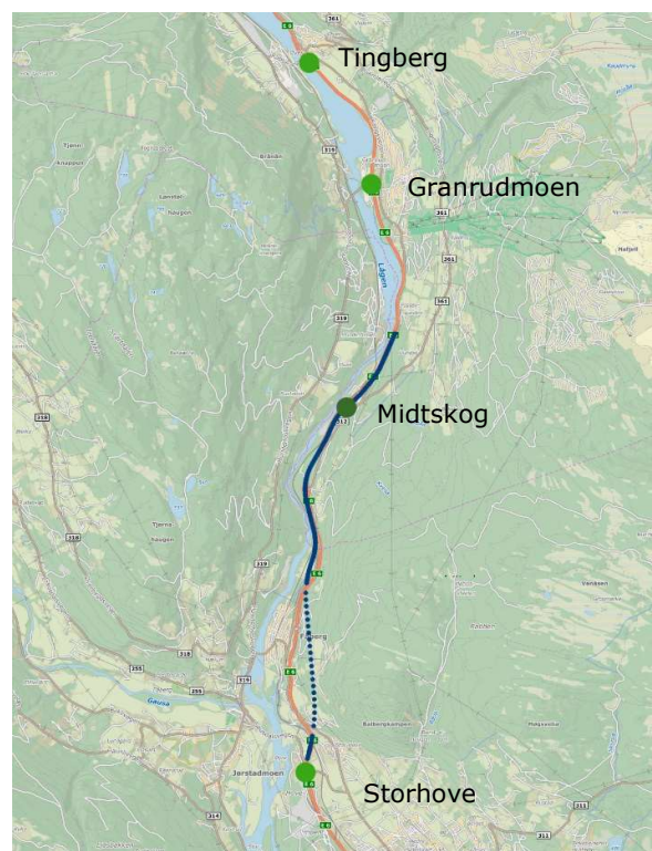
Alternativ C1. Halvkryss ved Midtskog og ny 110 km/t til sør for Hunderfossen. Deretter dagens veg med 90 km/t.
