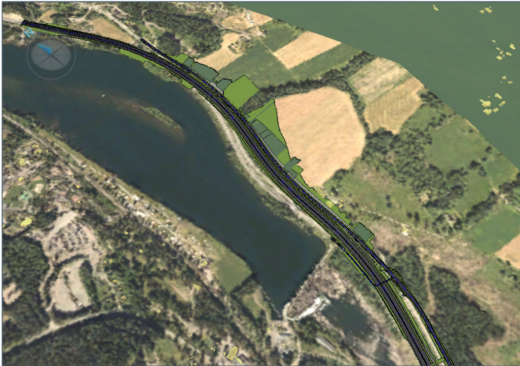
Figur 6-29: Selve tiltaket slik det er planlagt forbi delområde Merradalen. Her vist for alternativ A med skjæring som griper inn i eksisterende fulldyrket areal langs hele vestre del av delområdet Merradalen.
