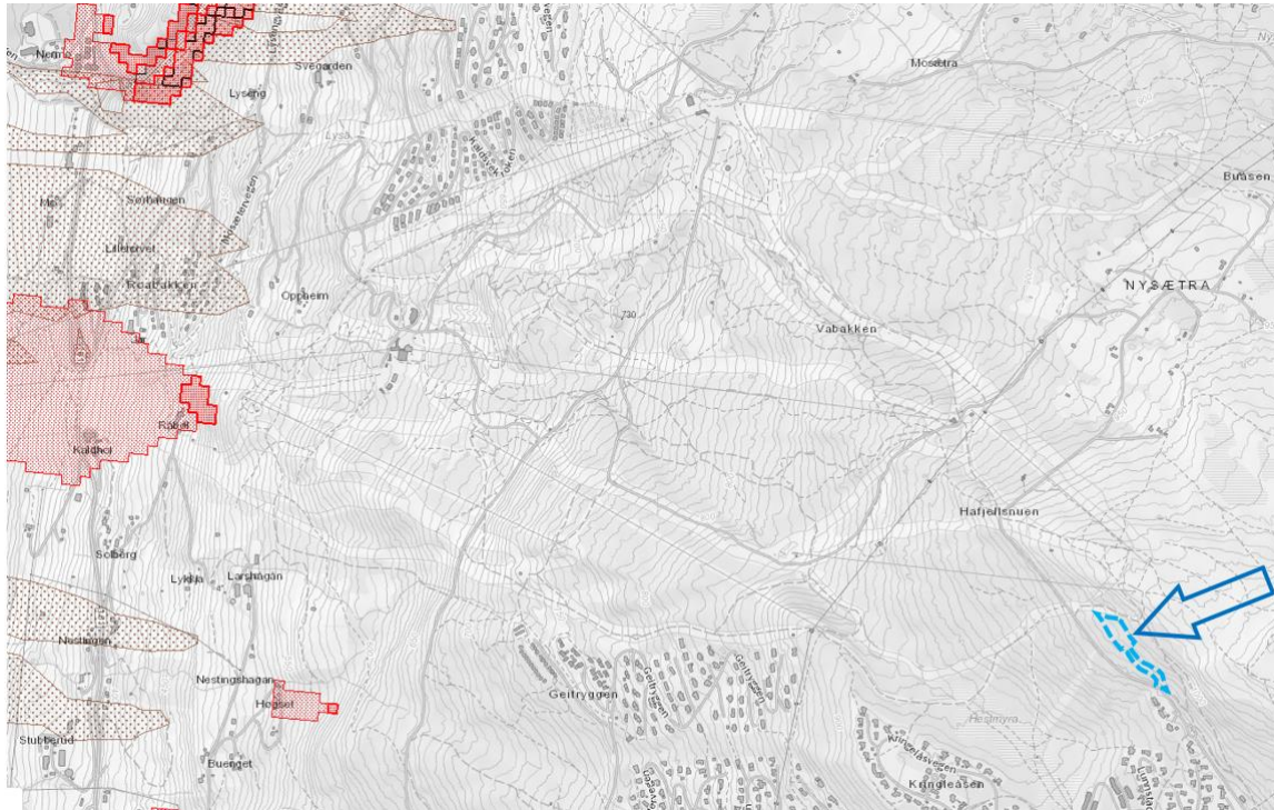
Planområdet ift NVE Atlas (Snøskred aktsomhetsområde = rød, Jord/flomskred aktsomhetsområde = brun, Flom aktsomhetsområde = grønn/blå)
