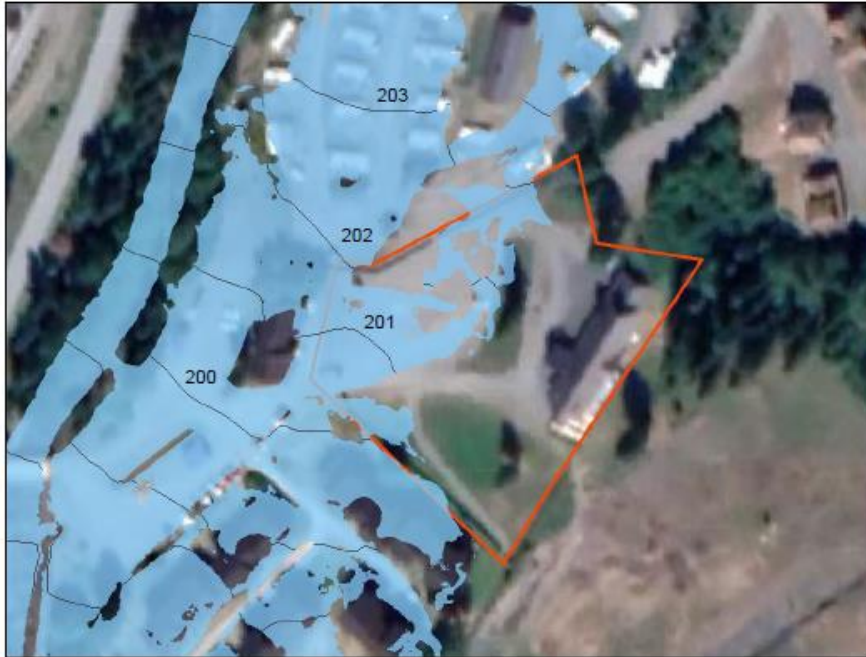
Vannstander ved Sagtomta med eksisterende terreng ved 200-års flom med klimapåslag (Rapport Norconsult AS 26.8.2019)
