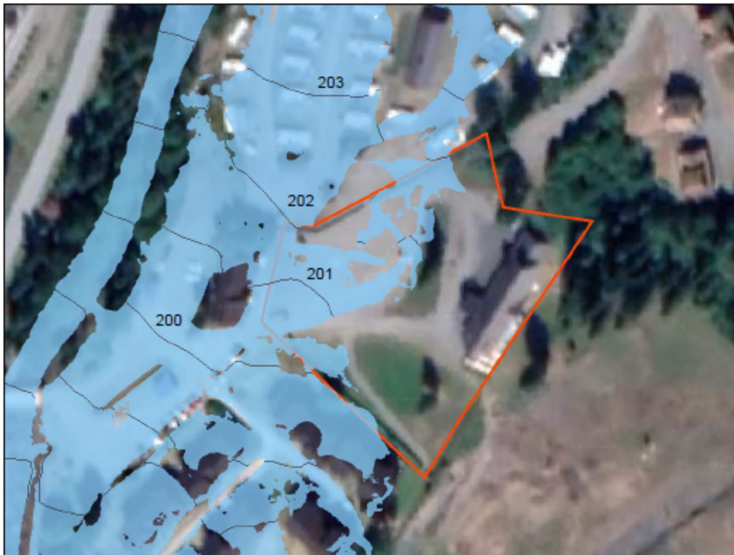
Figur 4: Vannstander (NN2000) ved Sagtomta med eksisterende terreng ved 200-årsflom med klimapåslag (73,4 m 3 /s)
