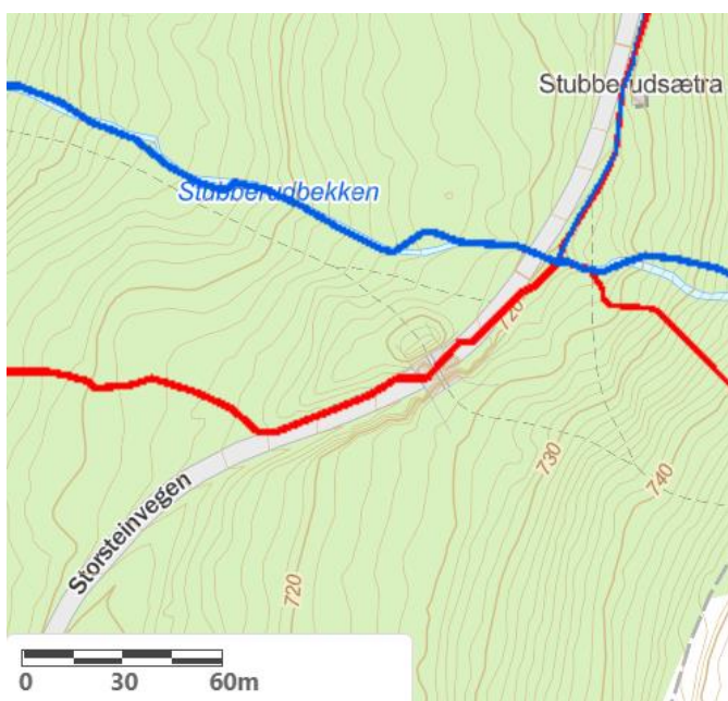
Figur 9 Oversiktsbilde over flomveiene (fra InnlandsGIS) der Stubberudbekken krysser Storsteinvegen. Rød avrenningslinje viser her flomvei inn mot planområdet langs vegen ved tett/ for liten kapasitet i stikkrenna.
