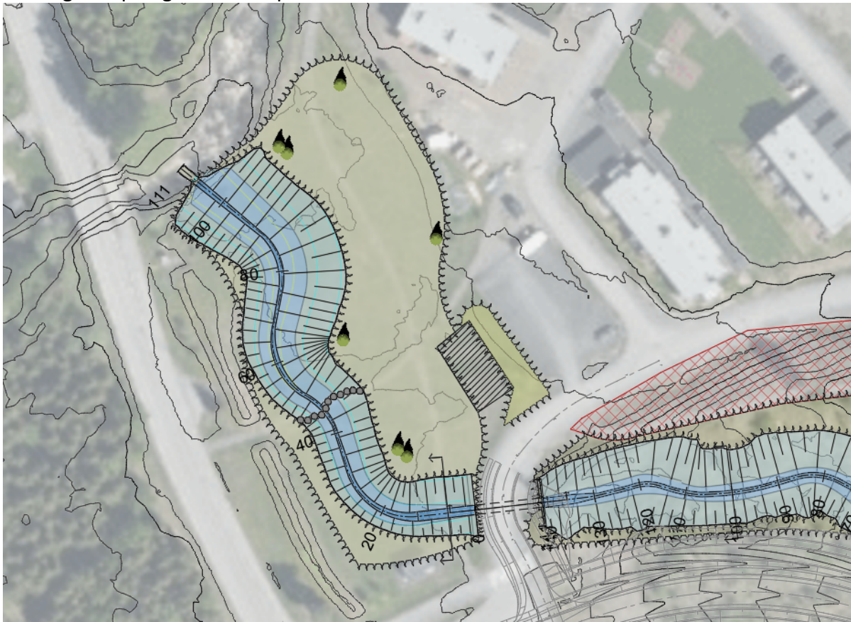
Skissert skråningsutslag for bekkeåpning mellom Ole Stenens veg og Søre Brynsåa (Illustrasjon Norconsult AS)
