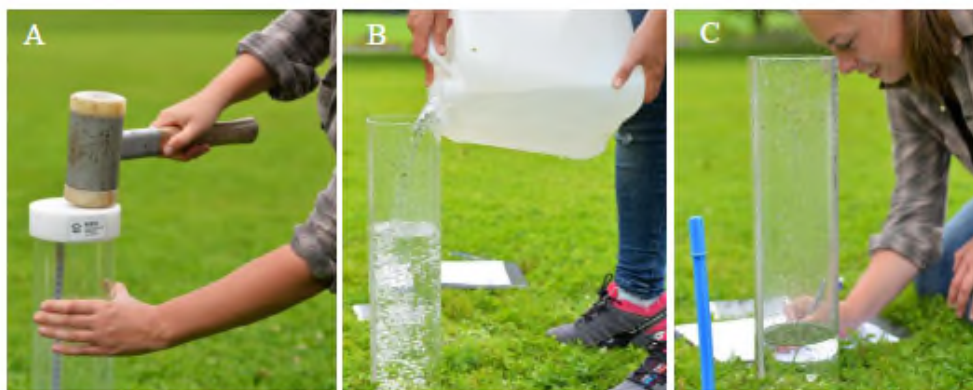
Figur 10 Bildeserie av utførelse av Modifisert Philip-Dunne infiltrrometer-metoden. Fotograf: Tone Mella.
