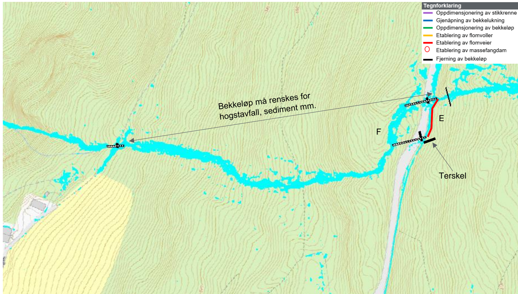
Figur 30: Tiltak i Skurgrasbekken ved punkt E og F. Bekken nedstrøms stikkrenner bør sikres med tilstrekkelig plass og erosjonssikring (spesielt mot vegfylling). På strekningen nedstrøms F var det spesielt mye hogstavfall og sedimenter i bekkeløpet som bør rykkes opp, da det øker sannsynligheten for problemer nedstrøms. Stikkrennene ved E antas å ha relativt god kapasitet totalt sett, men det bør legges til rette med en flomvei mellom og en terskel for å hindre videre drenerings langs vegen.
