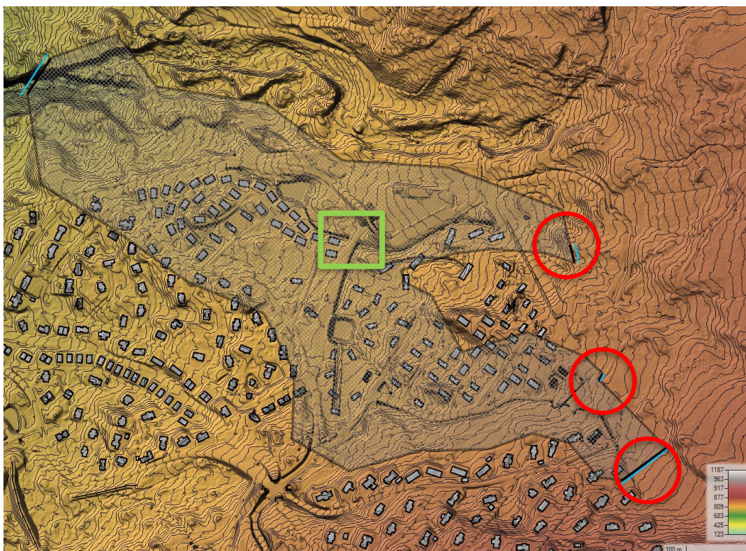
Figur 4-12: Modellområde for Nørdre Slåbekken (utsnitt fra HEC-RAS), grønn firkant viser utsnitt beskrevet i Figur 4-13:. Røde sirkler viser øvre grenser i modellen
