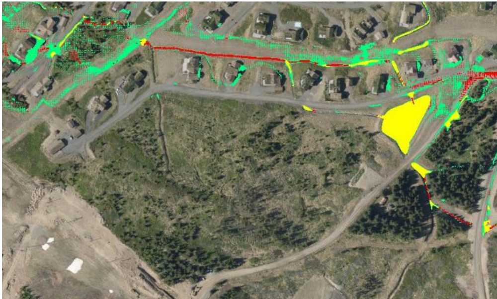
Figur 33: Beregnet farekart for eksisterende situasjon. (Multiconsult)
